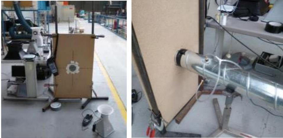
Figure 1 : Raccordement sur conduit droit rigide
