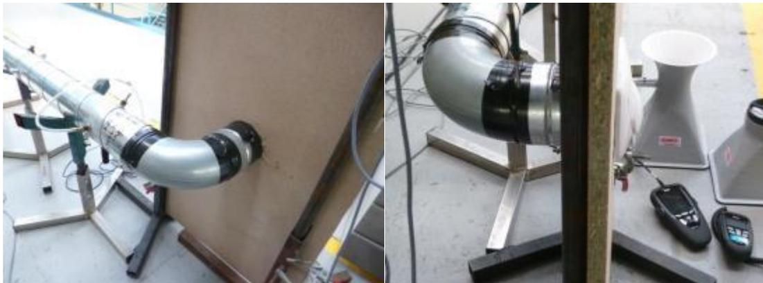
Figure 2 : Raccordement sur un coude à 90° suivi d'un conduit droit rigide
