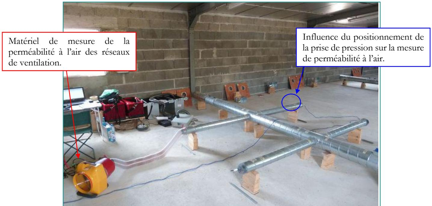
Figure 20 : Identification de la prise de pression du matériel de mesure de la perméabilité à l'air des réseaux de ventilation
