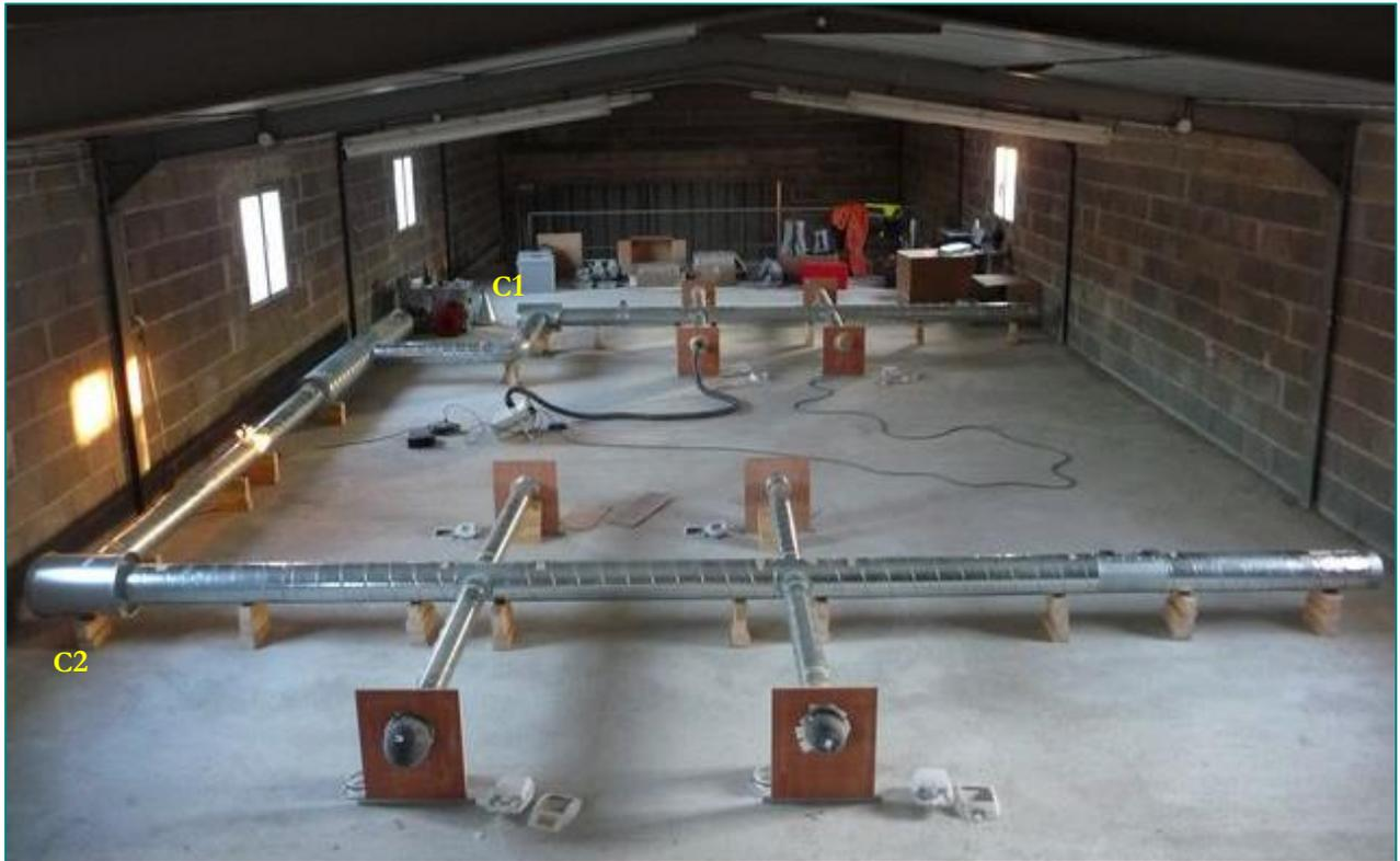
Figure 19 : Réseau de ventilation utilisé dans le cadre de la campagne d'essais
